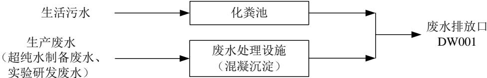
图 3-2 本项目废水处理工艺流程图
