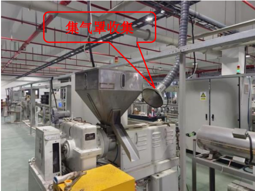
押出废气经集气罩收集
