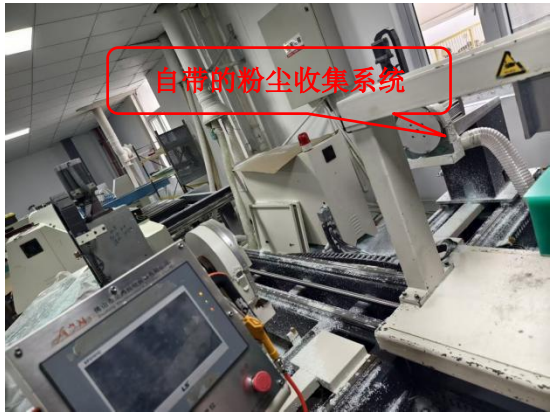
抛光机自带粉尘收集系统
