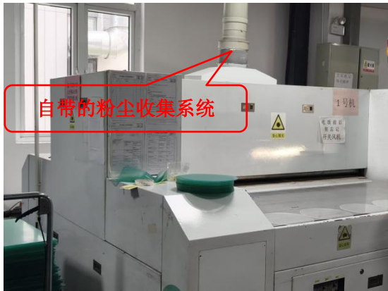
激光打点机自带粉尘收集系统
