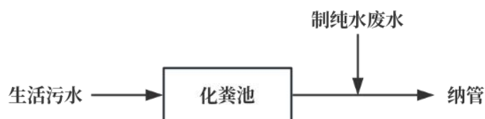
图 4-1 污水处理工艺流程
