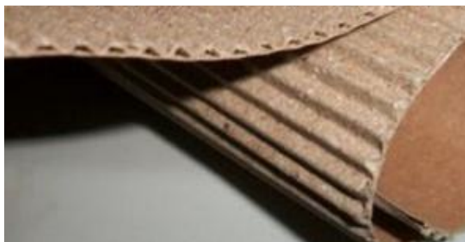
图 2-2 双层瓦楞纸板示意图
