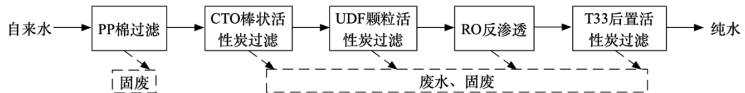
图 2-12 纯水制备工艺流程
