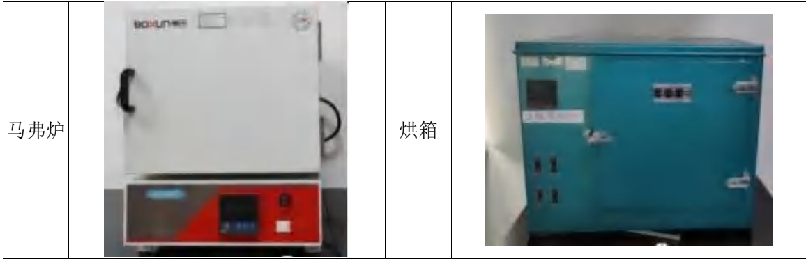
图 5.4-1 主要检测仪器设备照片
