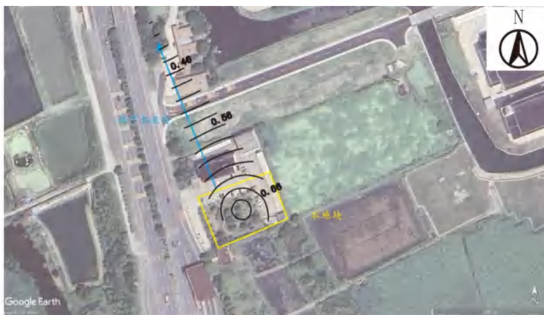
图 6-2 监测期间地下水流向示意图
