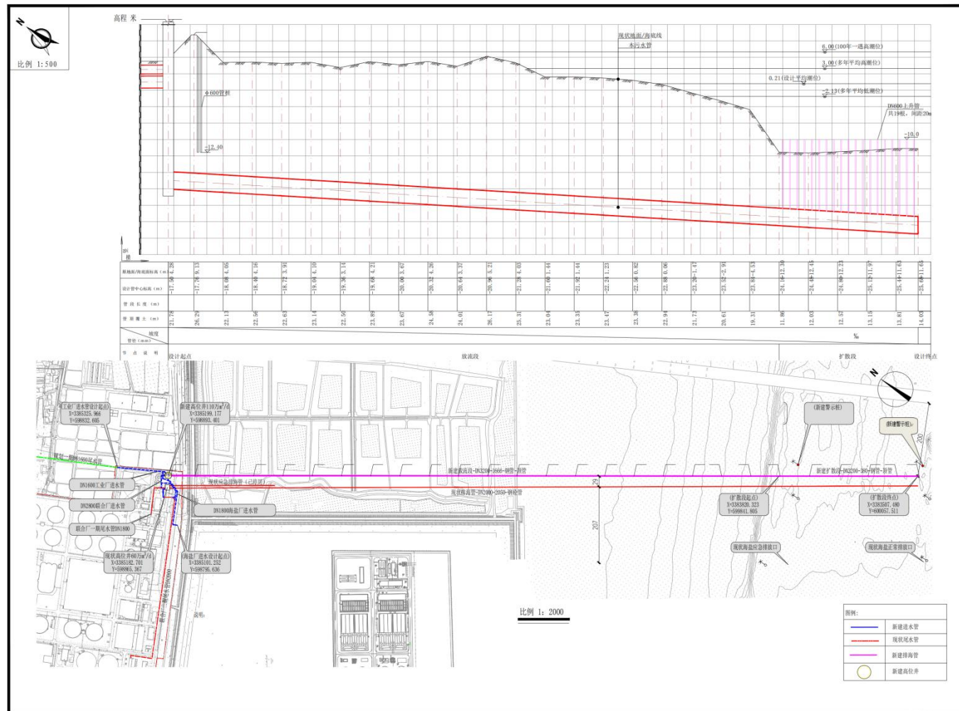
图 3.2-6 排海管平面布置及纵断面图
