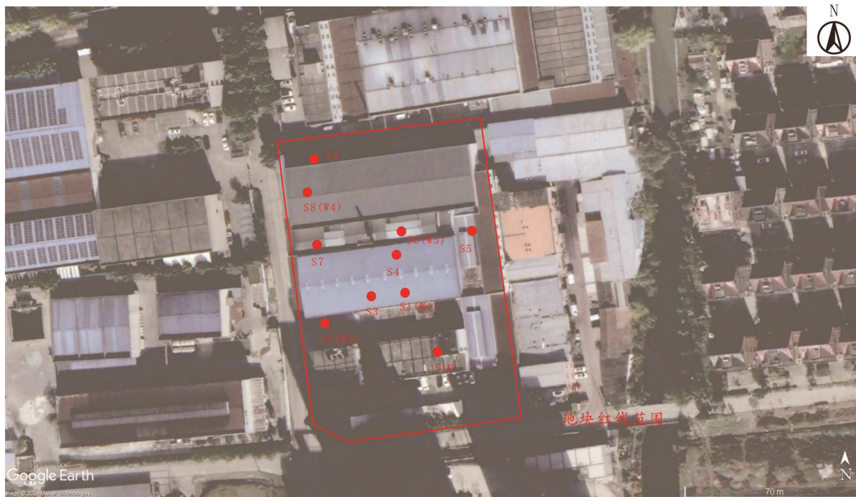
图 5-1 土壤、地下水地块内实际监测点位图
