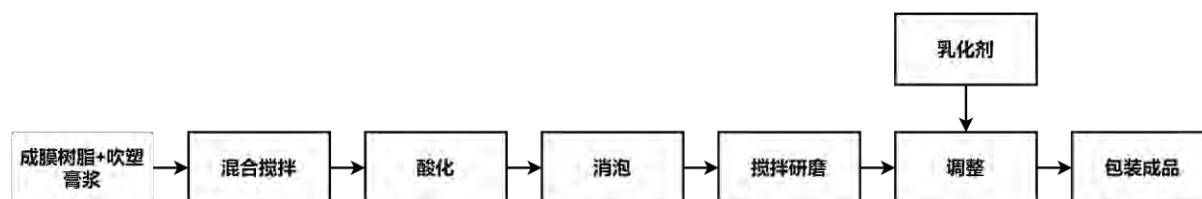
图 3-15 PP 膜叠影水膜生产工艺
