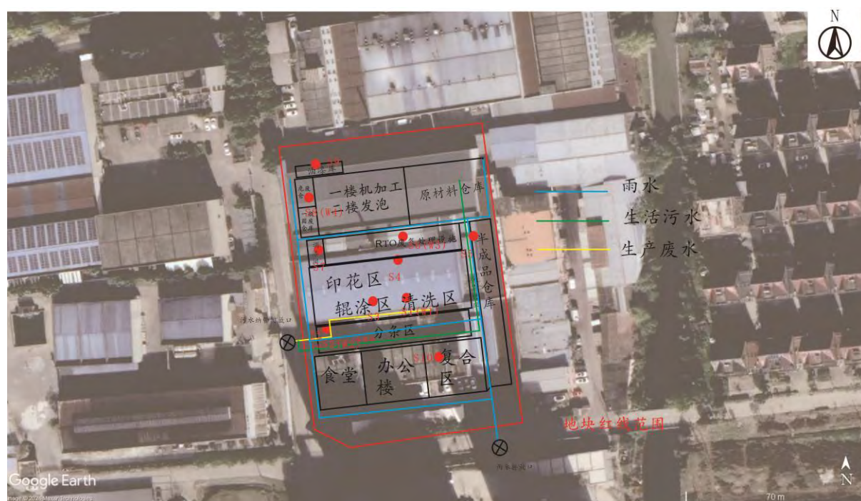
图 4-1 初步调查监测布点图 (土壤、地下水)
