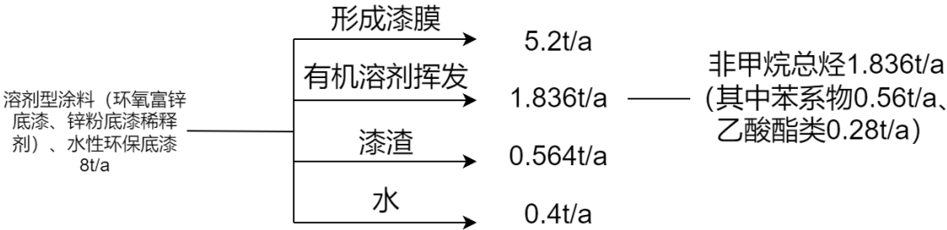
图 2-2 项目油漆物料平衡图
