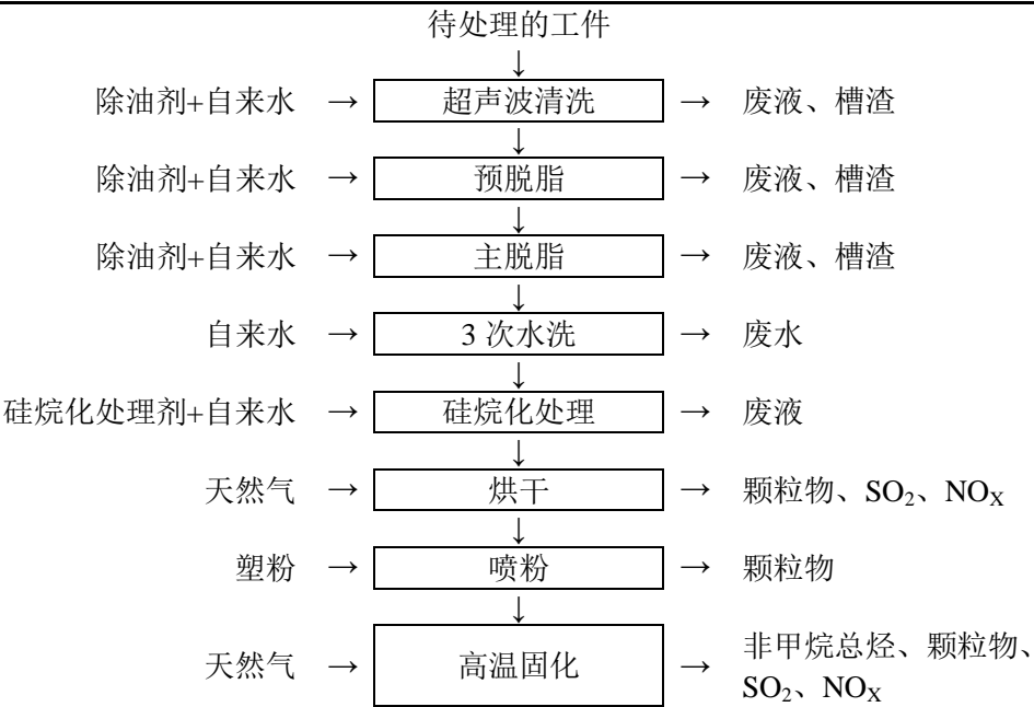
图 2-21 喷粉生产线生产工艺流程及产污环节图
