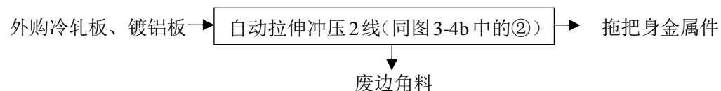
图 3-6a 拖把身金属件生产工艺流程图及产污环节（目前未实施）
